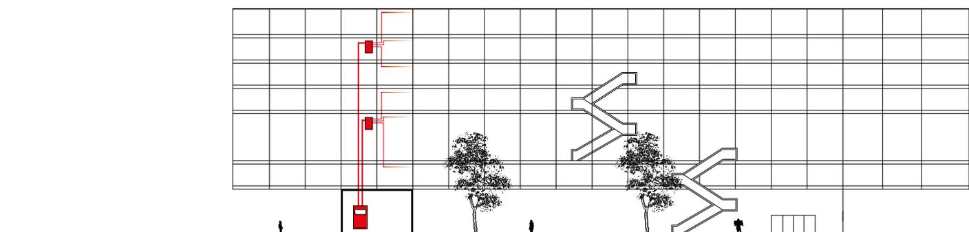
Équipé de sous-stations E60 résistants au feu, l'ONLITE central eBox alimente et surveille des bâtiments de moyenne à grande taille. Il est préférable que ce soit toujours un sous-station résistant au feu qui assure l'alimentation de plusieurs compartiments coupe-feu (étages) en tant que circuit final.
