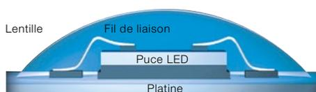
LED puce sur carte : la forme de la lentille détermine la distribution lumineuse
