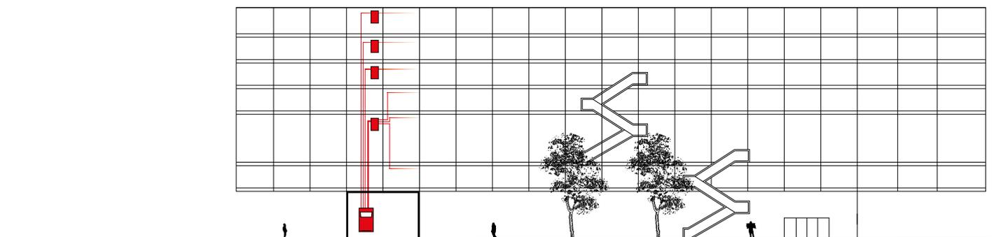
En tant que système d'éclairage de sécurité extensible, l'ONLITE central eBox alimente jusqu'à 30 circuits électriques et 600 luminaires de sécurité et à pictogramme. En utilisant des sous-stations, le système est idéal en termes de sécurité et de rentabilité pour les grands bâtiments. Les sous-stations apportent un avantage supplémentaire : ils réduisent jusqu'à 30 % les coûts d'installation et jusqu'à 70 % les charges incendie.
