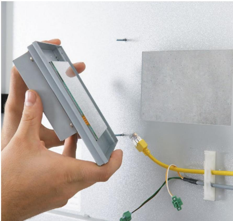
Une longue rangée de raccords signale les vastes possibilités proposées : l'ordinateur, construit sans éléments rotatifs et donc très robuste, est doté d'un système d'exploitation Windows CE Pro et d'une carte mémoire SD d'une capacité de 512 Mo. La tension d'alimentation 24 V et le bus de commande sont placés sur un même câble.
