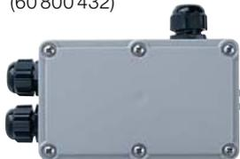
Diese kleine Anschlussbox IP 67 ermöglicht einen druckwassergeschützten Anschluss von bis zu drei geeigneten Zuleitungen (H07RNF, etc.) für Durchgangsverdrahtungen außerhalb eines Leuchtenkörpers. Sie kann alternativ zu selbstverschweißendem Klebeband oder auch Schweißmuffen eingesetzt werden.
