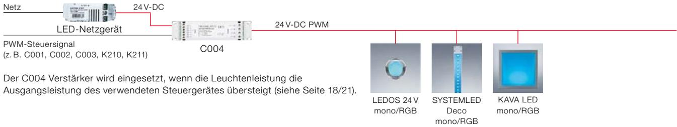
Der C004 Verstärker wird eingesetzt, wenn die Leuchtenleistung die Ausgangsleistung des verwendeten Steuergerätes übersteigt (siehe Seite 18/21).
