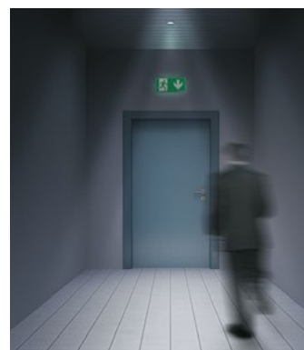
Iluminación con una luminancia del pictograma de 2 cd/m 2 .
