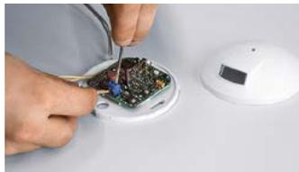
Il faut maintenant raccorder les capteurs appropriés ainsi que les appareils de commande sur la borne Control-In de l'appareil de base DIMLITE. Il n'est pas nécessaire d'installer un appareil supplémentaire dans l'armoire électrique, mais ...
