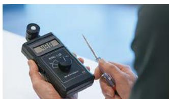
3 Mesurer l'éclairage sous chaque rangée de luminaires en un point significatif.
