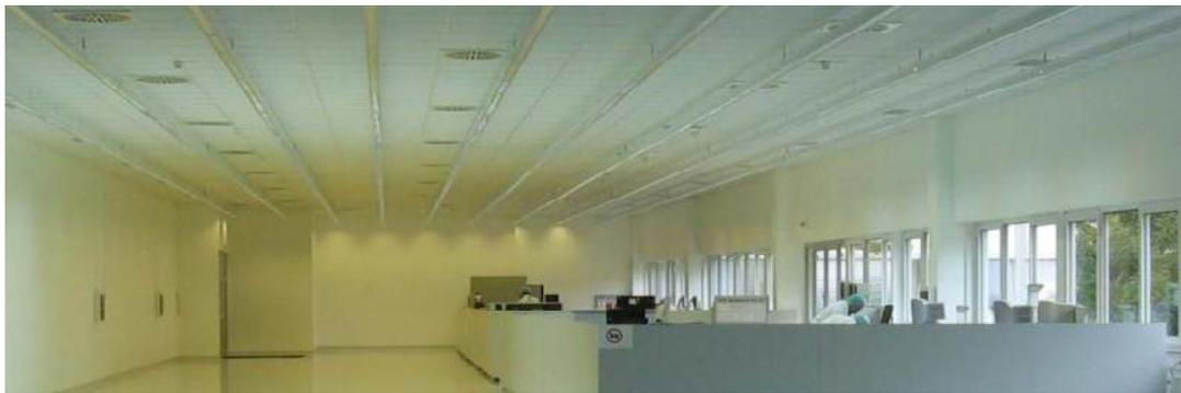
La salle de production peu après l'installation de l'éclairage en 2005. La salle n'est pas encore complètement aménagée et les deux parties sont intentionnellement éclairées par deux éclairages différents pour démontrer les différences de températures de couleur.
