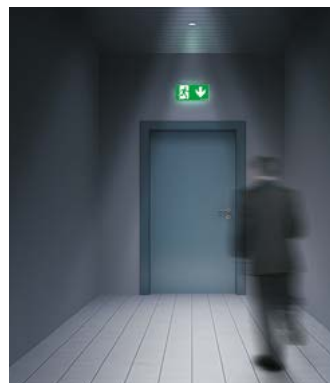
Verlichting van het pictogram met een luminantie van 200 cd/m 2
