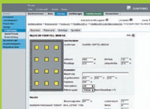
Schritt 2: Berechnungsparameter eingeben – schon wird die empfohlene Leuchtenanzahl berechnet
