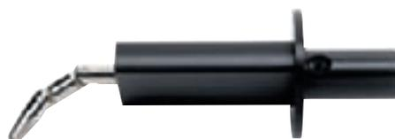
Chaque luminaire doit subir, à l'état installé, l'essai au doigt d'épreuve et ne peut être mis en vente si ce contrôle révèle qu'il est possible d'accéder de l'extérieur aux parties conductrices.
