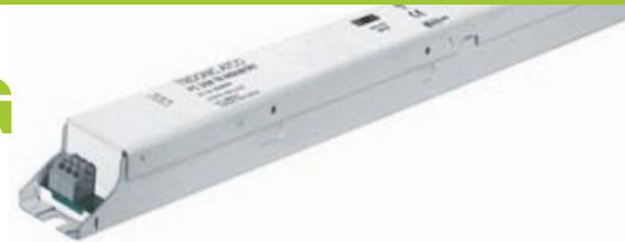
Das Industrie EVG bietet beste Voraussetzungen für die industrielle Anwendung. Es verbindet die Vorteile von elektronischen Vorschaltgeräten mit denen der magnetischen Geräte. Im Vergleich zum Standard EVG ist seine Lebensdauer erheblich höher, das Gerät hält höheren Temperaturschwankungen und Spannungsspitzen stand. Angeboten werden sie bei Zumtobel Staff für Feuchtraum-Wannenleuchten, Reinraumleuchten, Einzellichtleisten und Lichtbandsysteme.
