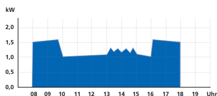
Energieverbrauch LENI: 44,25 kWh/m 2 a Die dimmbaren Leuchten kommen in der jeweils optimalen Intensität zum Einsatz.
