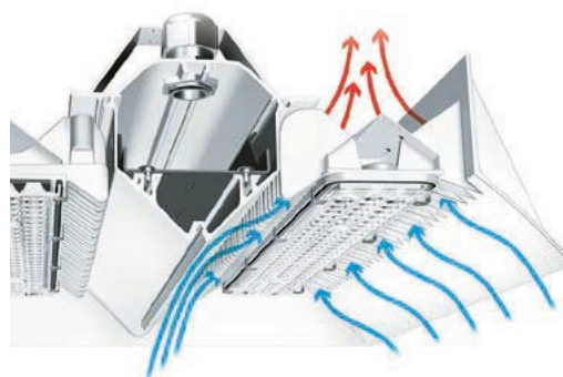
Des simulations comme on en fait pour les bolides de formule 1: c'est avec des images thermiques et une visualisation des flux d'air par un système à fumée que la gestion thermique du luminaire industriel GRAFT a été optimisée.
