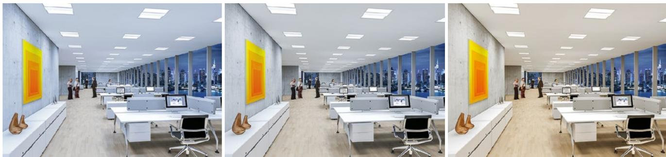
La technologie tunableWhite permet une variation dynamique de la lumière LED dans la plage du blanc. Ainsi, l'utilisateur peut modifier à sa guise et en continu la température de couleur entre par ex. 3000 et 6000 K.
