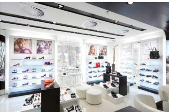
(8) Auch die Lichtlenkung in Regalen ist entscheidend: Eine flächige Hinterleuchtung von Regalen wirkt attraktiver als die ausschließliche Akzentbeleuchtung. Eine Kombination aus beidem unterstützt die Warenerkennung und erhöht die Attraktivität der inszenierten Waren.
