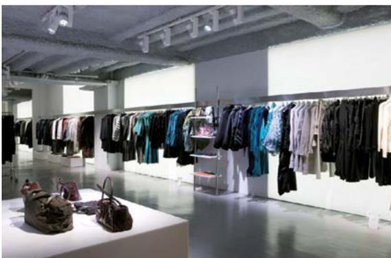
(4) Innerhalb eines Beleuchtungskonzepts werden unterschiedliche Lichtfarben bevorzugt. Verschiedene Farbtemperaturen zwischen Allgemeinbeleuchtung und vertikaler Beleuchtung sollten daher bewusst eingesetzt werden. Besonders die moderne LED-Leuchtentechnologie Tunable White, die einen Farbtemperaturwechsel mittels Steuerungssystemen möglich macht, kommt hierbei zum Tragen.
