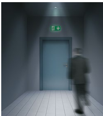
Éclairage du pictogramme avec une luminance de 2 cd/m 2
