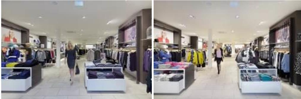
**Image 1** : Dans le cadre d'une étude de terrain et en coopération avec Gerry Weber, Zumtobel a renouvelé l'éclairage de la filiale de Herford en tenant exactement compte des préférences lumineuses du principal groupe cible. Il a réalisé un éclairage d'accentuation modéré aux couleurs de lumière chaudes. (Photo de gauche : avant, photo de droite : après)
