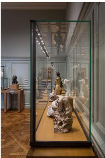
**Image 3:** Toutes les vitrines du musée sont équipées de modules LED MICROTOOLS, 4 000 K, à tête orientable avec optique Flood. L'intensité varie de 1 % à 35 % en fonction de la lumière du jour.
