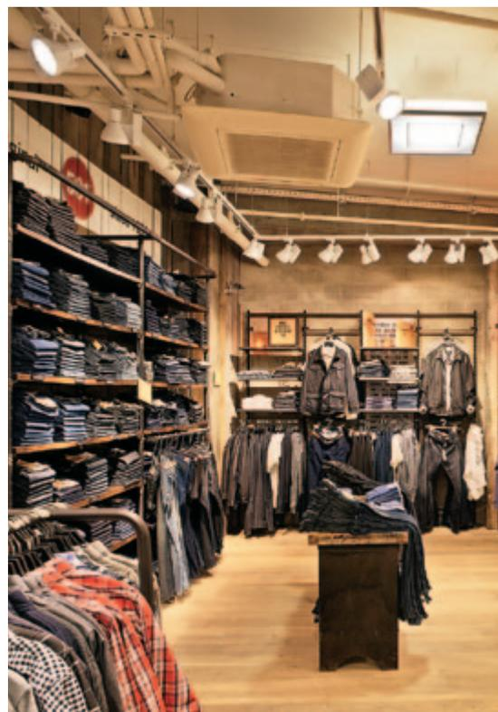
Une technologie visible : sans barrières visuelles, les suspensions pour l'éclairage restent visibles. Toutefois, cela ne perturbe nullement. Au contraire, cela vient compléter l'ambiance rassurante. Selon les besoins, les projecteurs peuvent être orientés en toute flexibilité. Quatre luminaires carrés à LED contribuent, en outre, à un éclairage de base agréable.
