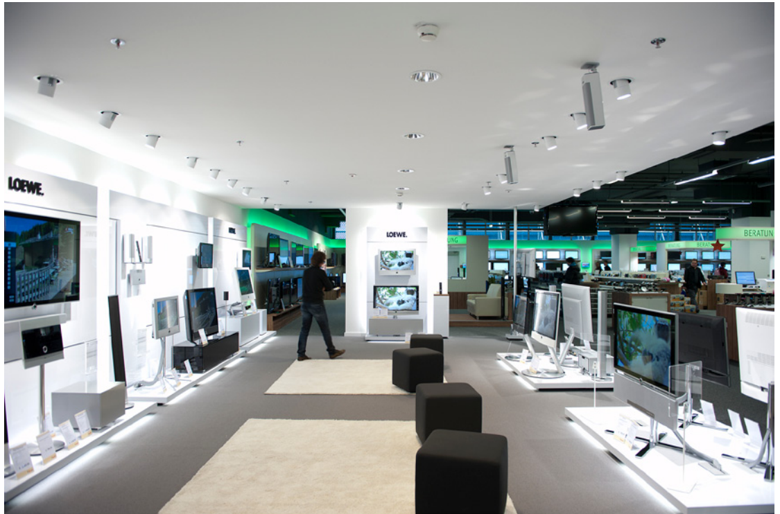
B3 | Die RGB LED-Lichtlinien werden über DMX Steuerung farblich verändert
