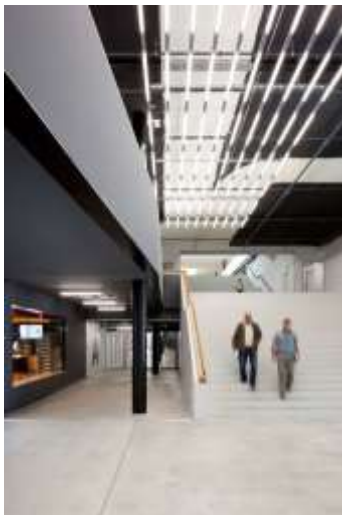
Bild 3: L'objectif du concept d'éclairage n'est pas de créer une luminosité homogène mais d'engendrer un dialogue entre zones claires et sombres en répartissant les luminaires par zones.
