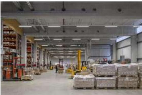
**Bild 4:** La consommation électrique annuelle est tombée de 1,2 millions à moins de 465 000 kilowattheures. Cela signifie une réduction de près de 139 tonnes/an d'émissions de CO<sub>2</sub> provenant de l'éclairage – autrement dit, seulement 38,6 % de la valeur précédente.
