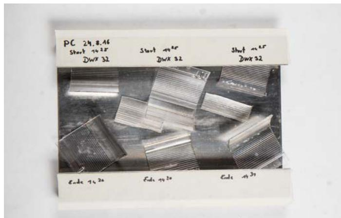
Materialtest bei Zumtobel. Polycarbonat zerbricht bereits nach wenigen Minuten bei Kontakt mit Ölen oder Schmierstoffen.
