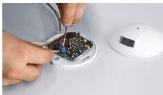
A continuación se acoplan los sensores y aparatos de mando en la entrada Control-In del módulo base DIMLITE. No se requiere montar un aparato adicional en el armario de distribución, ya que ...
