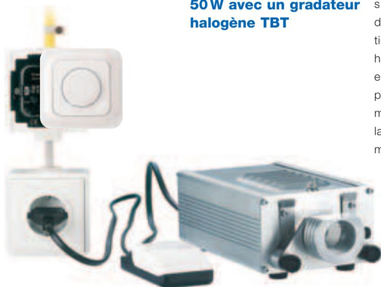
Sur le générateur halogène 50 W, le réglage de l'intensité s'effectue par le biais d'un gradateur halogène TBT conventionnel. Lorsque le gradateur halogène TBT doit commander en synchrone l'intensité de plusieurs générateurs de lumière, il est important d'observer la puissance absorbée maximale indiquée par le fabricant.
