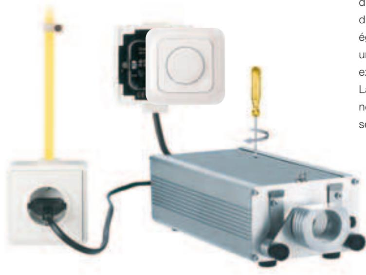
L'intensité du générateur halogène 100 W se règle à partir d'un potentiomètre incorporé dans le couvercle. Lorsque le générateur est placé à un endroit où le potentiomètre est difficilement accessible, il est également possible d'installer un potentiomètre électronique externe (100 K  $\Omega$  linéaire). La mise en/hors circuit du générateur de lumière se fait séparément.
