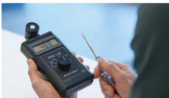
3 Andate sotto ognuna delle file di apparecchi e misurate l'illuminamento in un punto rilevante.
