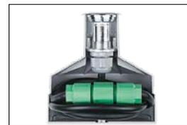
Montage à l'extérieur : pour la dérivation des eaux souterraines, un lit de drainage d'environ 20 cm d'épaisseur doit être assuré en dessous du boîtier monté à ras du sol. La connexion à l'alimentation en tension s'effectue en dehors du boîtier d'encastrement dans des boîtiers de bornes correspondants.
