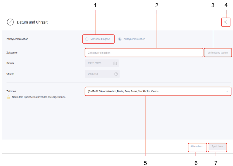
Bild 6: Funktionen in der App "Datum und Uhrzeit" bei aktivierter Zeitsynchronisation
