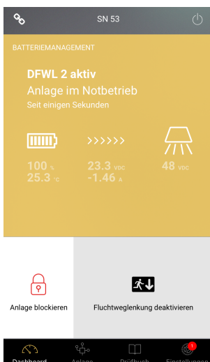
Bild 6: Ansicht "Dashboard" mit aktiver Fluchtweglenkung "DFWL 2" und Anlagenstatus "Notbetrieb"
