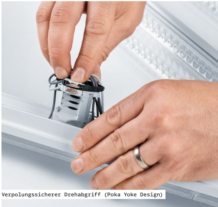
Am Schienenende Ausspeiser oder Berührungsschutz montieren
