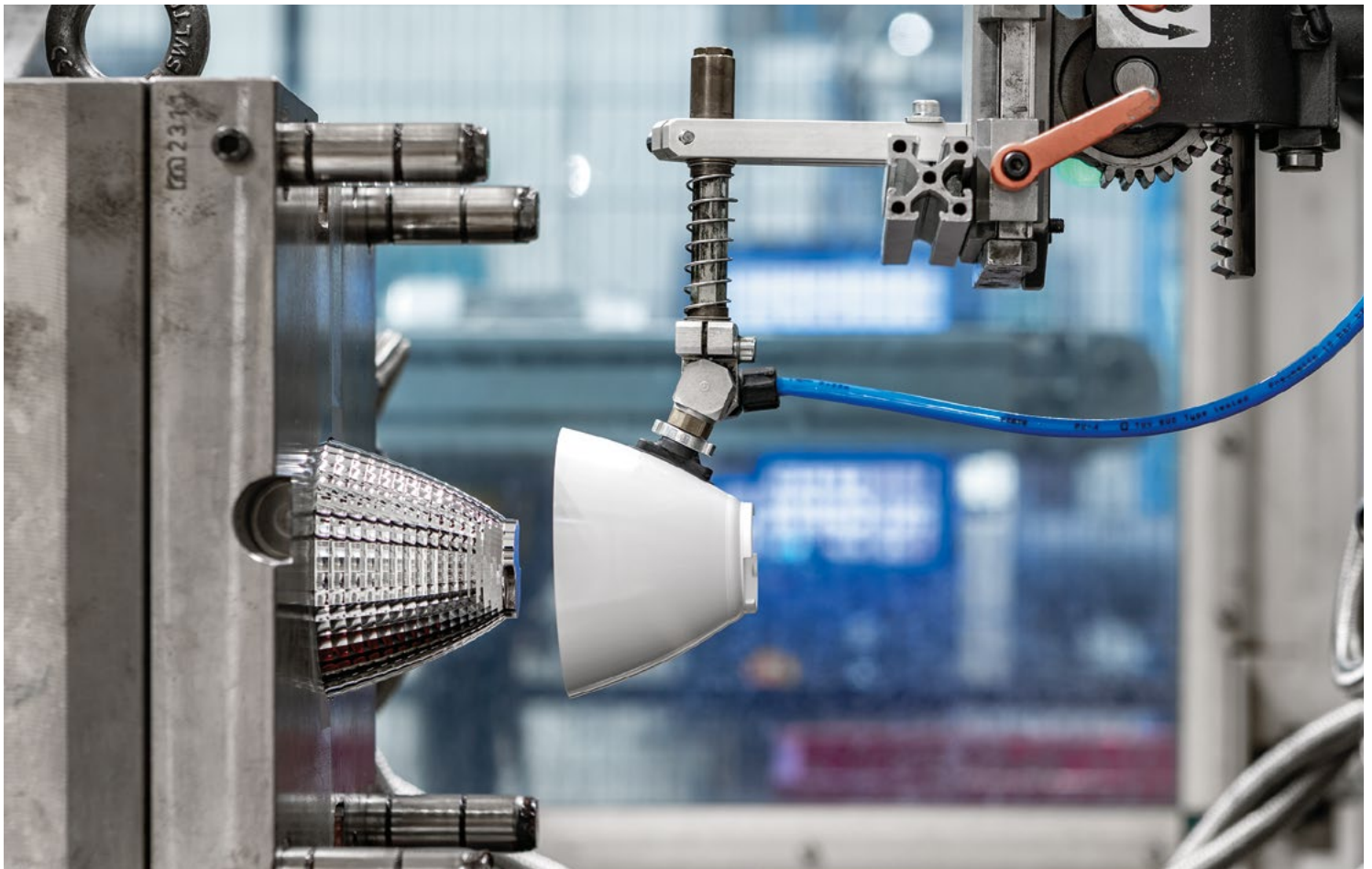
Réflecteurs moulés par injection très efficaces, pulvérisés, conçus et fabriqués par Zumtobel en Allemagne
