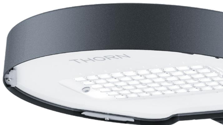
Carat è progettato per resistere alla prova del tempo. Questo apparecchio incredibilmente duraturo è realizzato con materiali della migliore qualità. Corpo in fusione di alluminio EN AC-44300, con un trattamento per aree costiere come standard. Ciò, in combinazione alle viti in acciaio inossidabile trattate con zinco, permette il raggiungimento della classe di corrosione C5, in linea con la EN ISO 9223.
