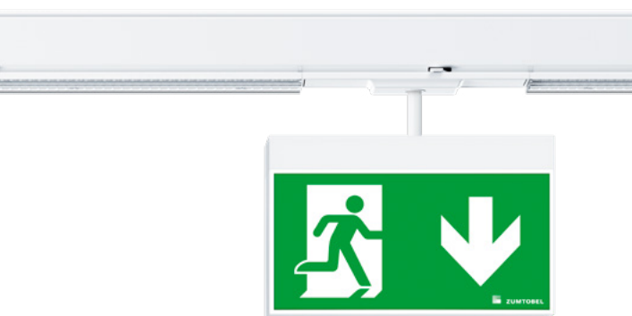
CROSSIGN: De CROSSIGN LED-armatuur combineert de nieuwste technologie met een gelijkmatige lichtverdeling dankzij een speciale PMMA-lens en biedt veelzijdige, kostenefficiënte toepassingsmogelijkheden met eenvoudige installatie. Twee draaibare ERI-lenzen maken bovendien gebruik als noodverlichting mogelijk.
