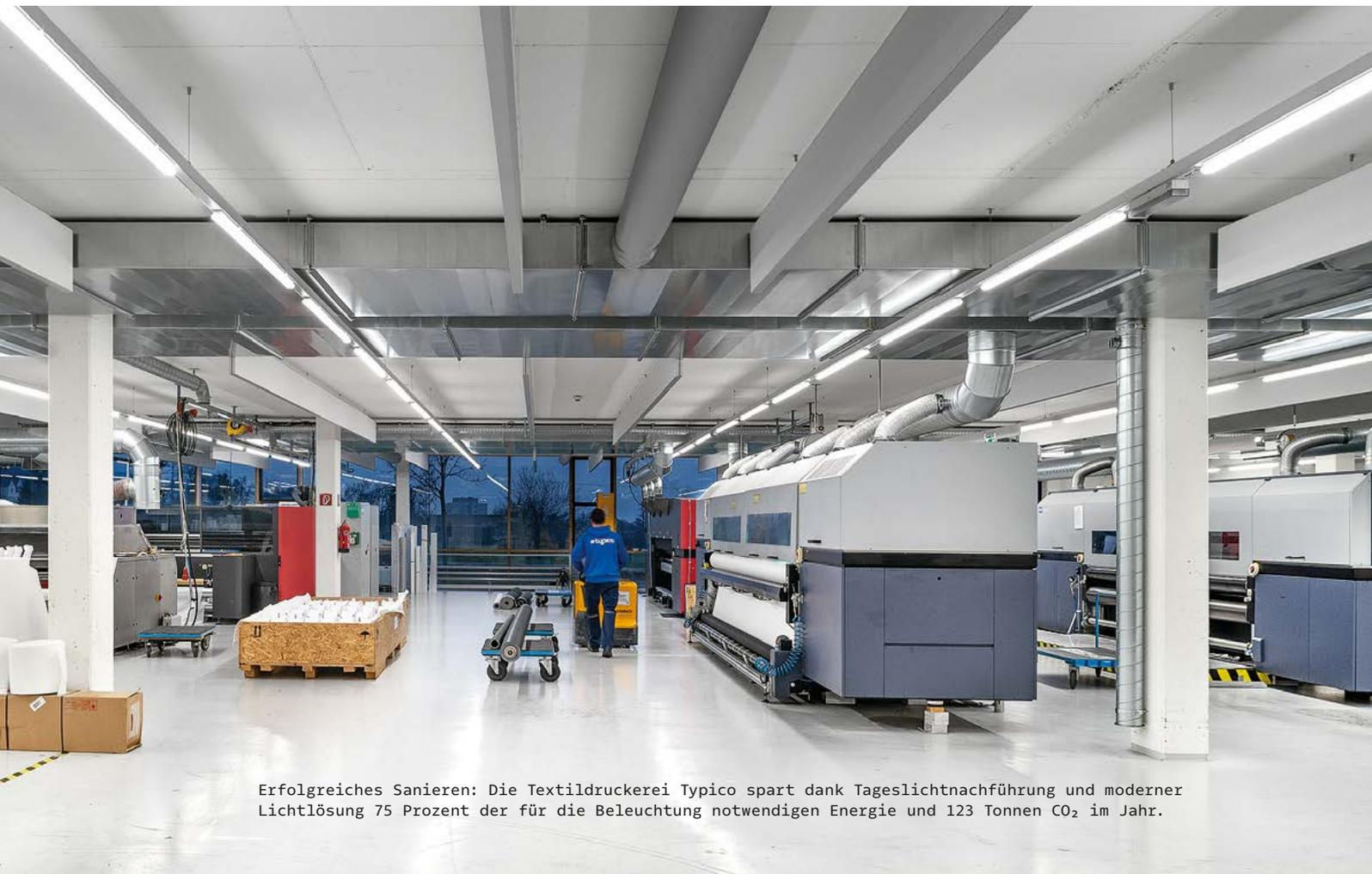
Erfolgreiches Sanieren: Die Textildruckerei Typico spart dank Tageslichtnachführung und moderner Lichtlösung 75 Prozent der für die Beleuchtung notwendigen Energie und 123 Tonnen CO<sub>2</sub> im Jahr.
