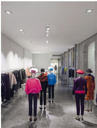
**Foto 3:** Sui manichini sono puntati doppi faretto d'accento del programma [INTRO](#), uno ad emissione spot e uno flood, incassati nel soffitto a filo superficie.
