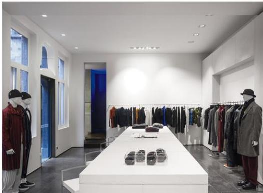
**Foto 2:** I doppi moduli del sistema INTRO, bianchi e senza cornice, si fondono con il soffitto diffondendo una luminosità omogenea che fa risaltare le collezioni.
