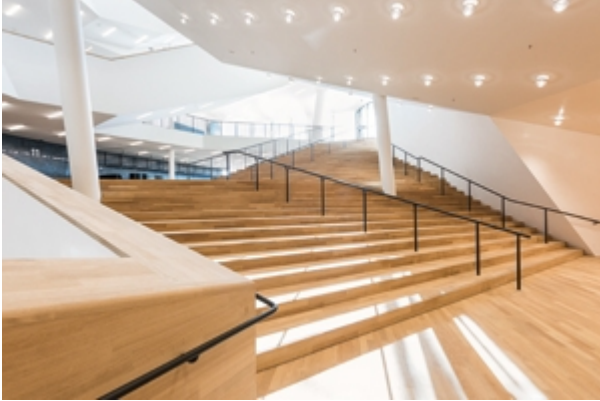
Bild 4: Eine weitere Sonderleuchte entwickelte Zumtobel speziell für das Foyer und die Garderobe vor dem Konzertsaal. Es handelt sich um eine Hybridleuchte mit handgefertigter Leuchtstoffröhre und einem RGB LED-Modul.
