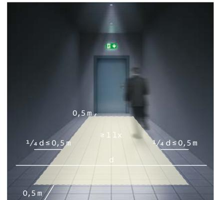
Die Aufgabe der Notbeleuchtung für Fluchtwege ist es, Personen das gefahrlose Verlassen eines Raumes oder Gebäudes zu ermöglichen, indem für ausreichende Sehbedingungen und Orientierung auf Fluchtwegen und in besonderen Bereichen gesorgt wird, und dass Brandbekämpfungs- und Sicherheitseinrichtungen leicht aufgefunden und bedient werden können.
