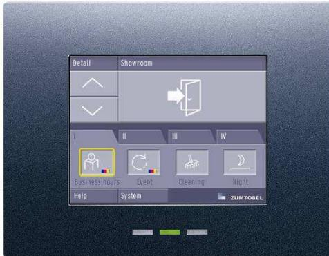
L'efficacia di una facciata illuminata dipende dalla qualità degli apparecchi usati e dalla scelta di un giusto sistema di comando. Se non si vuole limitarsi ad accendere e spegnere l'impianto bensì regolarlo in modo dinamico, allora serve un sistema di gestione. Il touchpanel
