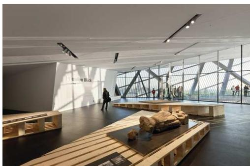
Il sistema Tecton a 11 poli è inserito in profili di alluminio a forma di H e U. L'insieme alimenta la corrente alternata trifase, i comandi della luce
