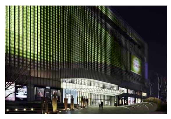
B2 I Un sistema di comando DMX gestisce singolarmente 22.000 proiettori LED coordinandoli in un'esclusiva illuminazione della facciata. Zumtobel ha realizzato il progetto seguendo il lighting design dello studio ag Licht.
