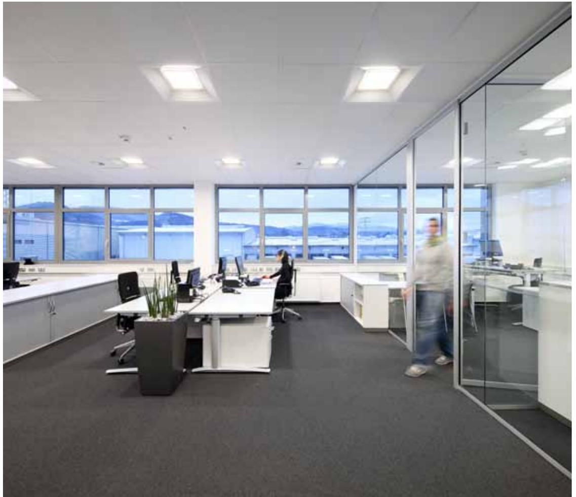
B2 | La soluzione illuminotecnica basata in gran parte sui LED è di esempio per un'illuminazione da postazione di lavoro efficiente sul piano energetico e di alto livello qualitativo. Il LED downlight Crayon, montato come soluzione speciale a filo con il soffitto, garantisce un uso flessibile dei locali.
