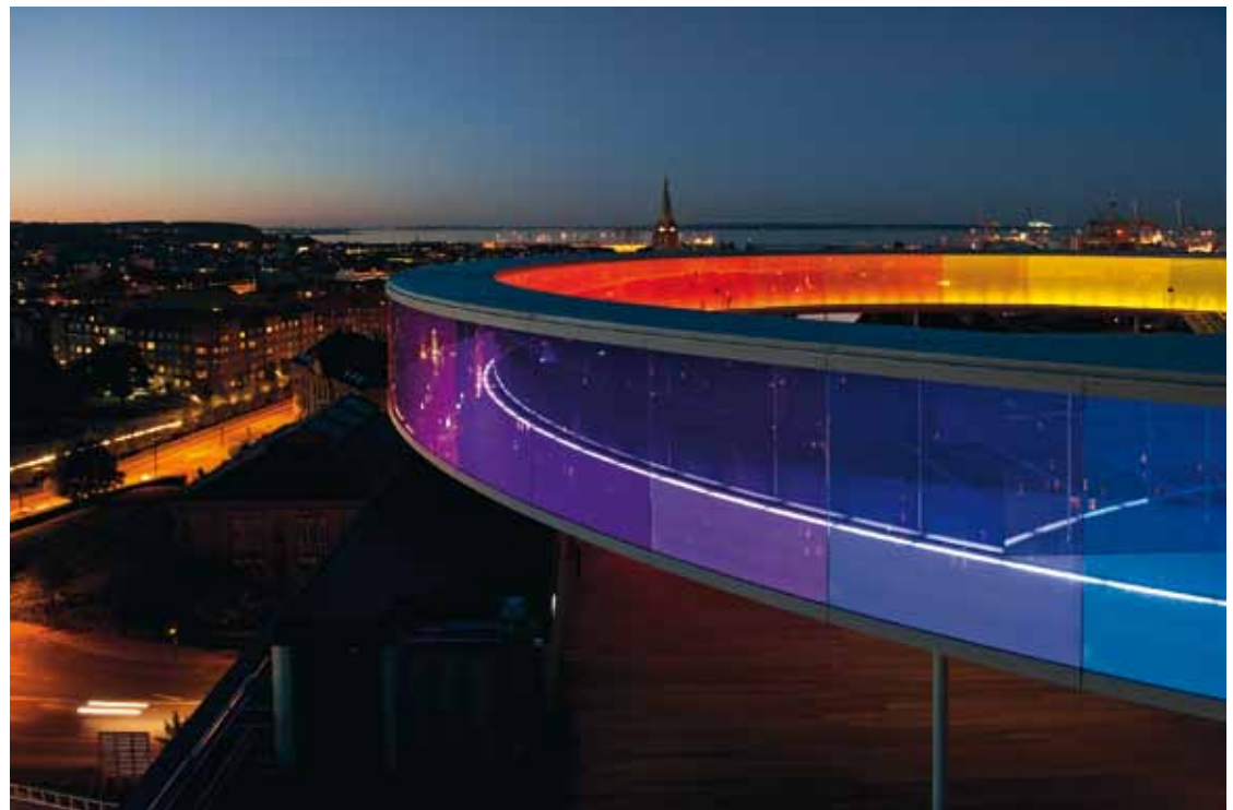
B2 | Apparecchi speciali incassati nel pavimento fanno brillare l'installazione in tutti i colori dello spettro, proprio come un vero arcobaleno. A tale scopo viene illuminato in modo simmetrico il soffitto che a sua volta fa risaltare i vetri.
