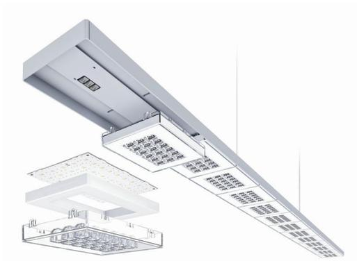
**Bild 2:** Sequence ist als Pendel- und Anbauleuchte konzipiert und besteht aus wahlweise acht oder 14 baugleichen, aneinandergereihten Moduleinheiten mit je 6 x 3 mittig angeordneten LED-Lichtpunkten.
