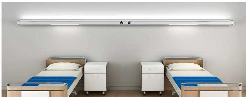
Foto 2: Camera a due letti con fila continua LED (luce generale) e singoli moduli LED (luce di lettura e per visite mediche).
