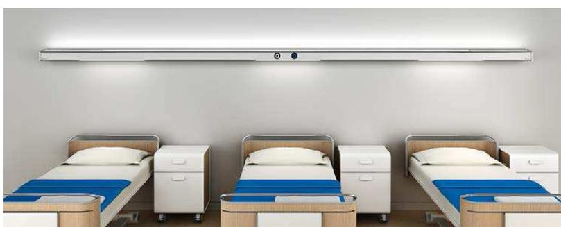
Foto 3: Camera a tre letti con fila continua LED (luce generale) e singoli moduli LED (luce di lettura e per visite mediche).
