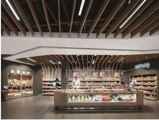
Bild 4: Les produits de boulangerie sont éclairés par des projecteurs VIVO LED et CARDAN LED, intégrant l'innovante technologie « Stable White » dans une température de couleur de 3000 kelvins.
